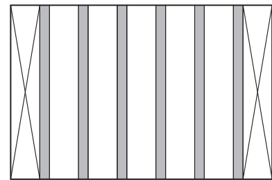
幅55サイズ スチール折板 7枚 1山ポリカ折板 6枚
