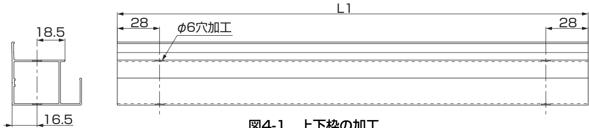
図4-1 上下枠の加工
